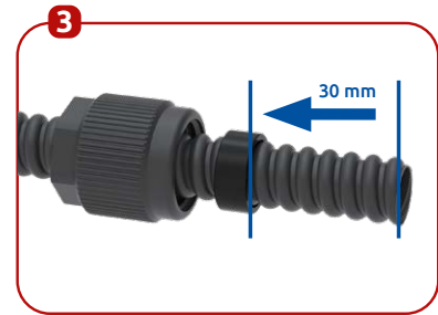
Mutter und Dichtring müssen mind. eine Kupplungslänge weit (30 mm) auf den Schlauch geschoben werden
